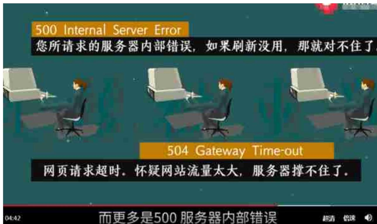
其实403代表着服务器理解你的请求, 但是拒绝执行。414代表请求的URI太长, 所以服务器懒得读。500代表请求的服务器内部错误, 所以刷新没用。504代表怀疑网站流量太大, 所以服务器崩溃了。看完这些之后, 是不是涨知识了呢?
