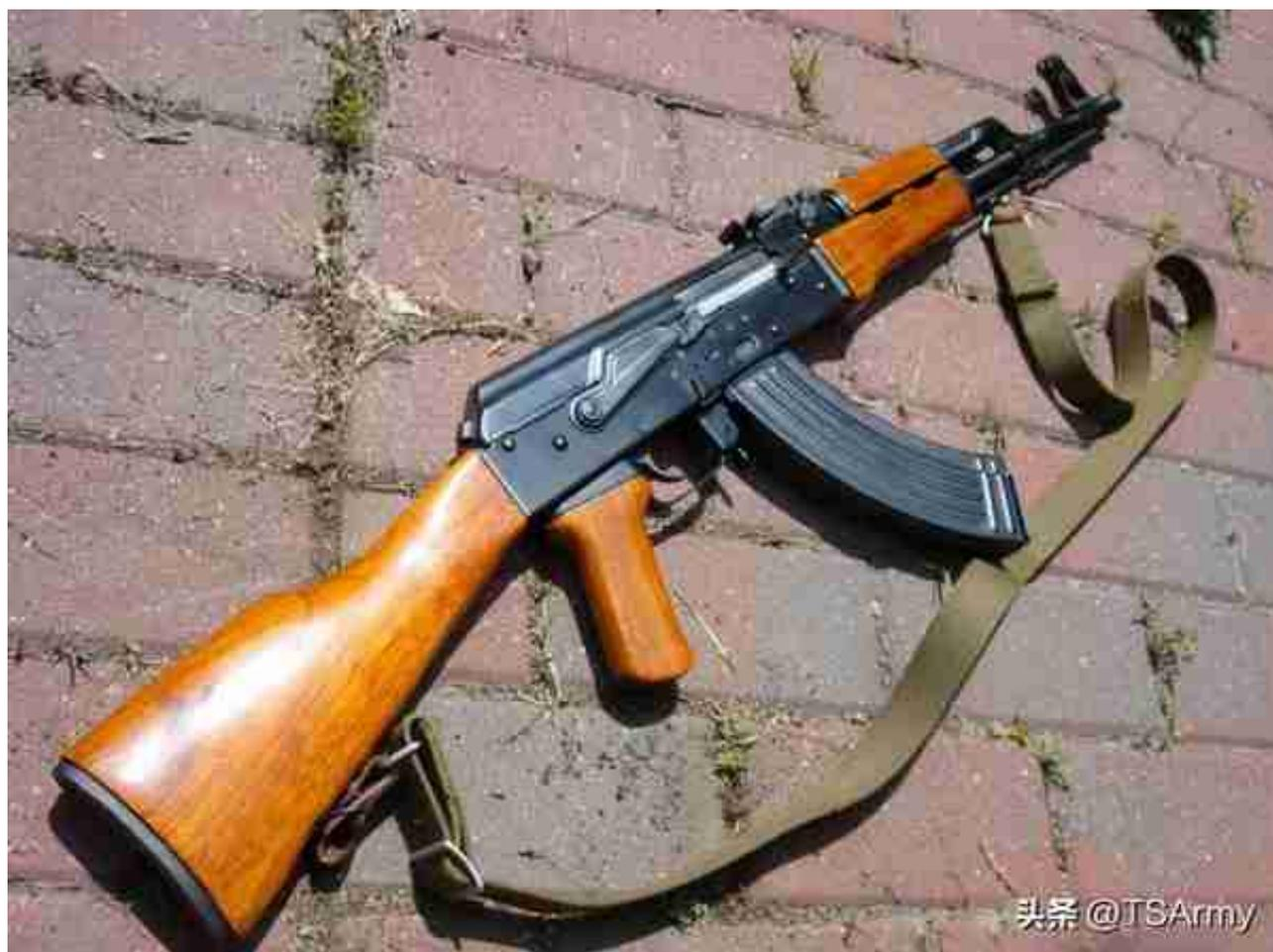
56式冲锋枪，实际上就是56式自动步枪，由于当时我们对自动武器的认知较为落后，所以就称它为冲锋枪，56式自动步枪在1956年定型，模仿前苏联的AK47突击步枪设计，表面上看起来基本一模一样，但两者最大的区别就是56式的前部准星是圆形包起状态，而AK47是半圆形豁口状态，在外观上两者是这样区分的。
