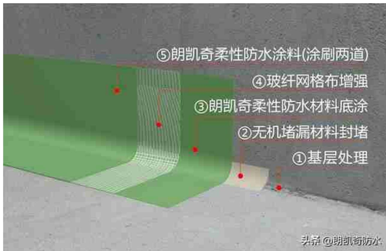
先检查基层是否平整，面层有凹凸不平处时，用水泥砂浆找平，确保基层平整、坚实、无浮灰。然后用堵漏王对阴角进行抹弧处理，在阴角处采用“一布三涂”的防水施工工艺，先底涂一层防水涂料，再铺设一层无纺布或玻纤网格布，最后再涂刷两遍防水涂料。
